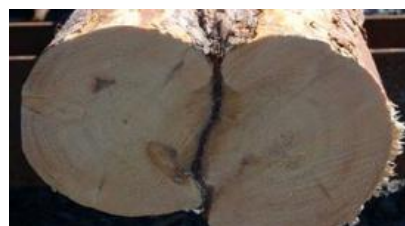
Kinnised harud – õhku ei ole peatüve ja haru vahel. Koor võib olla.
