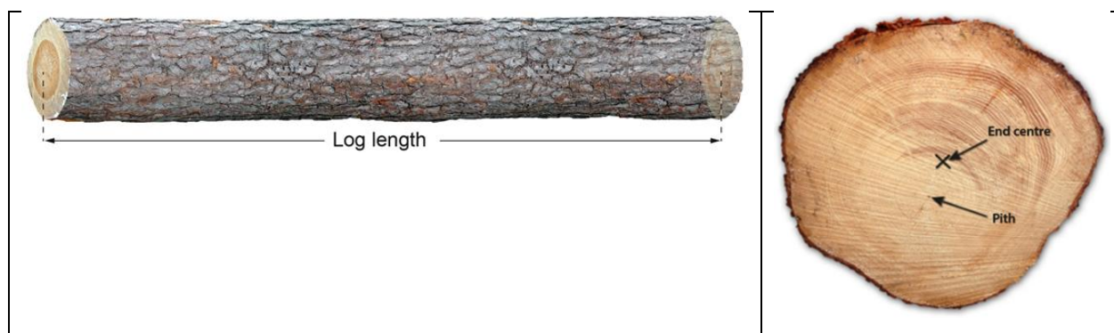
Joonis 2. Noti pikkuse all mõistetakse noti otspindade keskkoha vahelist vähimat kaugust. Keskkohaks on otspinna geomeetriline keskkoha. [Log length – noti pikkus; End centre – otspinna keskkoha; Pith – säsi]
