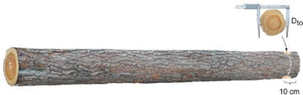
Joonis 10. Läbimõõdu mõõtmiskoht ladvapoole otsa läbimõõdu mõõtmisel.
