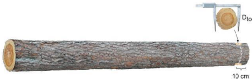
Joonis 10. Läbimõõdu mõõtmiskoht ladvapoole otsa läbimõõdu mõõtmisel.
