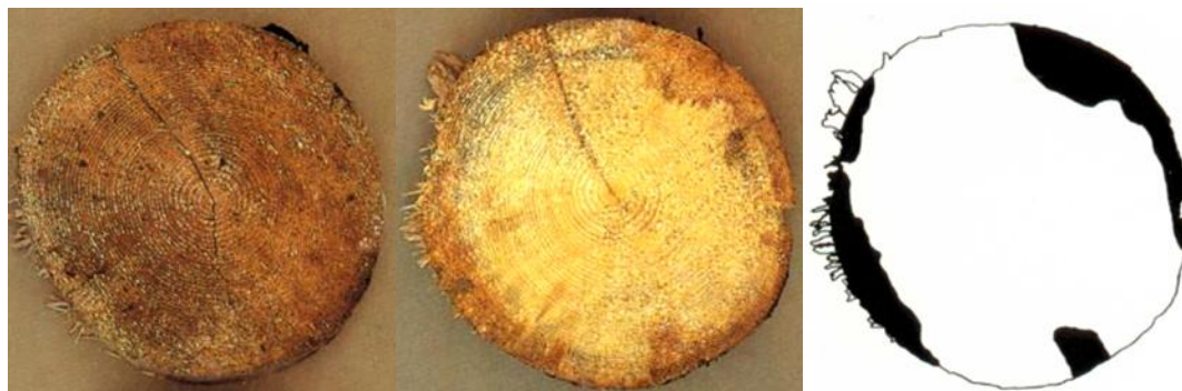
Joonis 7. Kuuse laomädanik. Vasakul: noti otsa pind; Keskel: lõige noti otsast 15 cm kauguselt; Paremal: mustaga on märgitud laomädanikuga osa. Noti diameeter 20 cm, 25 % laomädanikku. (Rötskador i massaved, Swedish Forest Agency, 1989).
