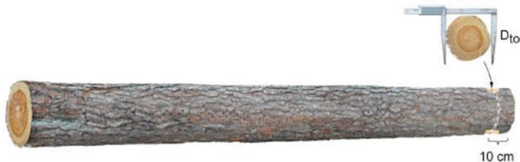
Joonis 10. Läbimõõdu mõõtmiskoht ladvapoolse otsa läbimõõdu mõõtmisel.
