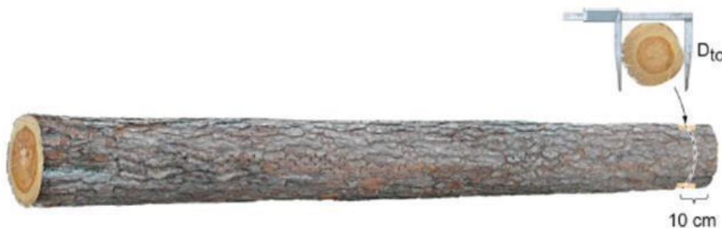
Joonis 10. Läbimõõdu mõõtmiskoht ladvaotsa mõõtmisel.
