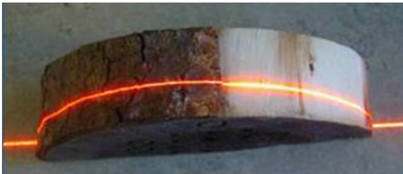
Joonis 8. Koorealuse läbimõõdu trahheiidide meetodil mõõtmise põhimõtte. Mõõteraamil kasutatav laservalgus hajub puidus rohkem kui koores. Pildi analüüsimisel kiire laiust ja intensiivsust mõõtes on võimalik puitu koorest eristada.
