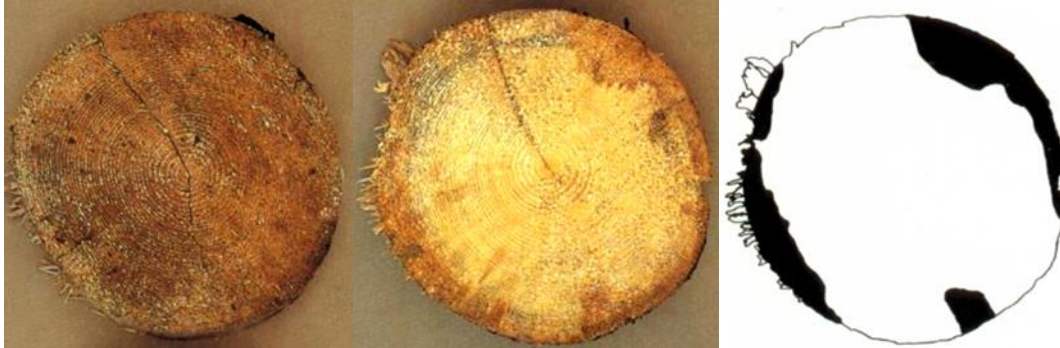
Joonis 7. Kuuse laomädanik. Vasakul: noti otsa pind; Keskul: löige noti otsast 15 cm kauguselt; Paremalt: mustaga on märgitud laomädanikuga osa. Noti diameeter 20 cm, 25 % laomädanikku. (Rötskador i massaved, Swedish Forest Agency, 1989).
